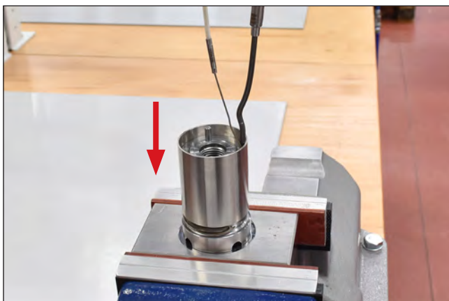
Abbildung 122: Thermofühler verlegen, Schutzrohr nachschieben
