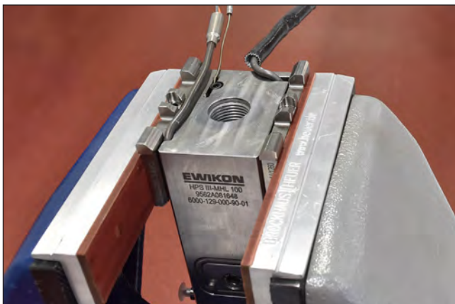
Abbildung 109: Thermofühler in die Bohrung stecken und fixieren
