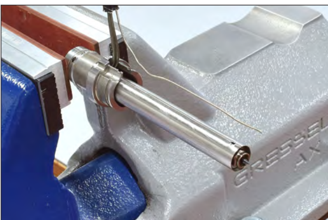
Abbildung 87: Defekten Thermofühler demontieren
