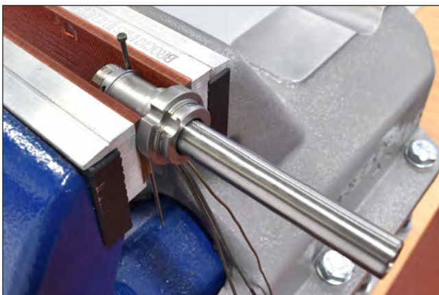
Abbildung 82: Vorzentrieren um die Spannhülsen zu montieren
