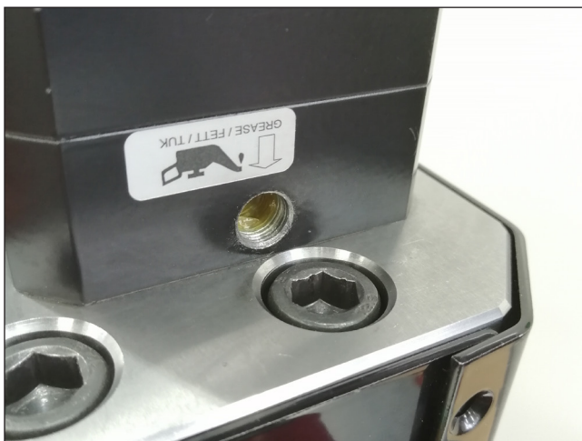
Abbildung 113: Gewindebohrung für die Schmierung des Servo-Antriebs
