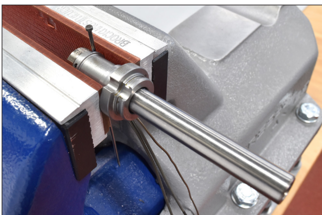
Abbildung 94: Vorzentrieren um die Spannhülsen zu montieren
