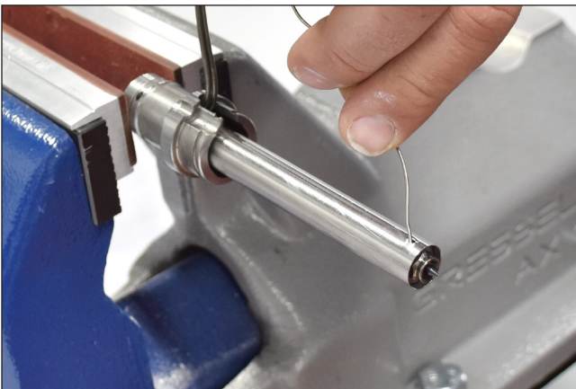
Abbildung 101: Thermofühler in die Bohrung der Düse stecken
