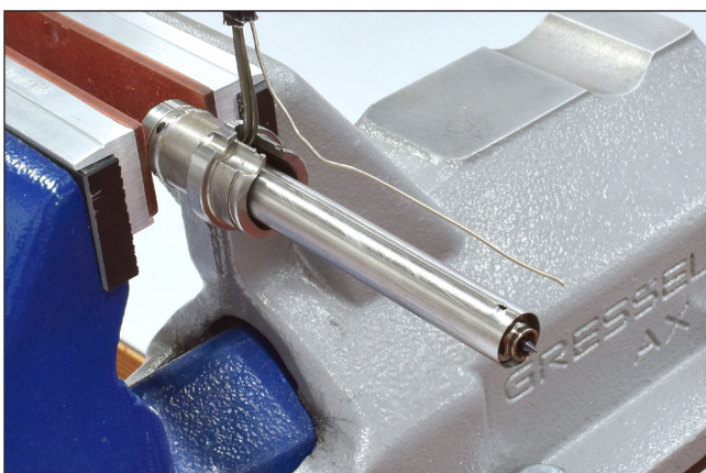
Abbildung 99: Defekten Thermofühler demontieren
